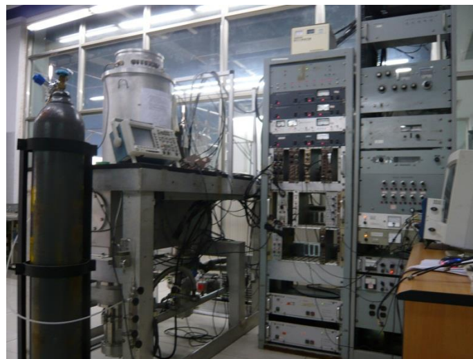
图 4. 全角度(e,2e)电子动量谱仪
