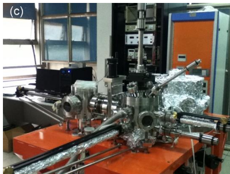
图 2 (a)(b)谱仪示意图；(c)实物图
